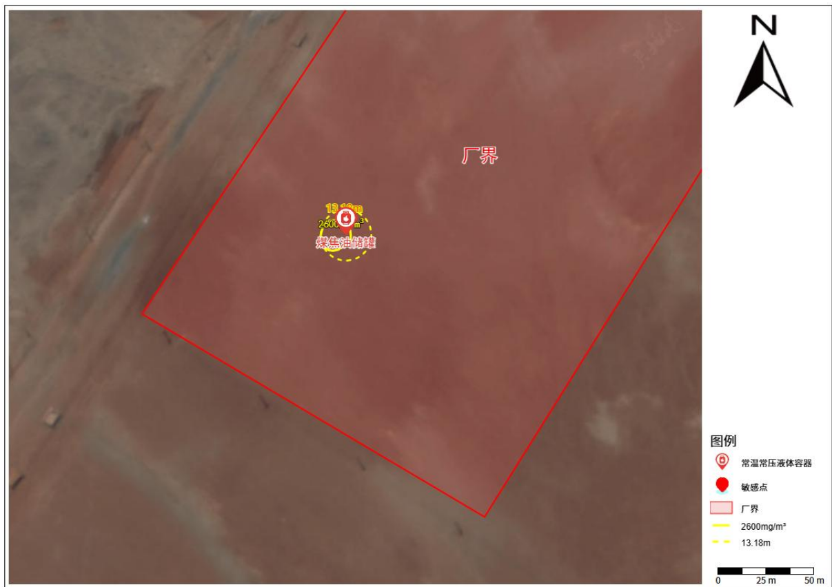
图 6.5-1 最不利气象条件下煤焦油储罐破裂苯泄露环境影响范围
