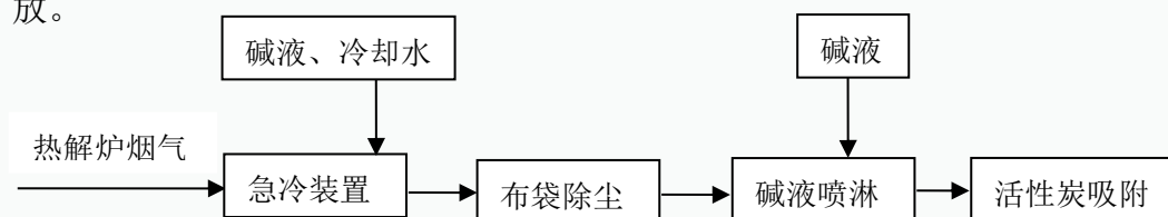
图8.1-2 热解炉废气治理措施工艺流程图
